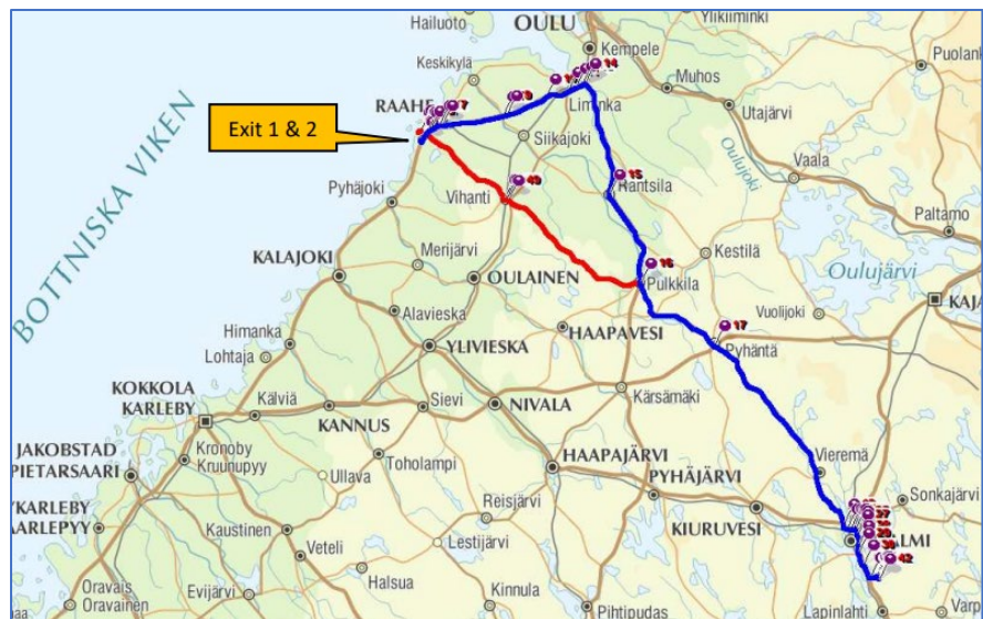
Kuva 62. Toteutettavissa oleva reittisuunnitelma Raahen satamasta Tielammen suunnittelualueelle. Sinisellä tornien ja punaisella lapojen kuljetusreitit. © Kuljetusliike Ville Silvasti Oy
