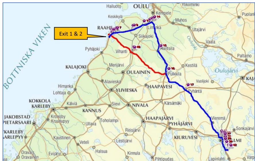
Kuva 66. Toteutettavissa oleva reittisuunnitelma Raahen satamasta Tielammen suunnittelualueelle. Sinisellä tornien ja punaisella lapojen kuljetusreitit. © Kuljetusliike Ville Silvasti Oy
