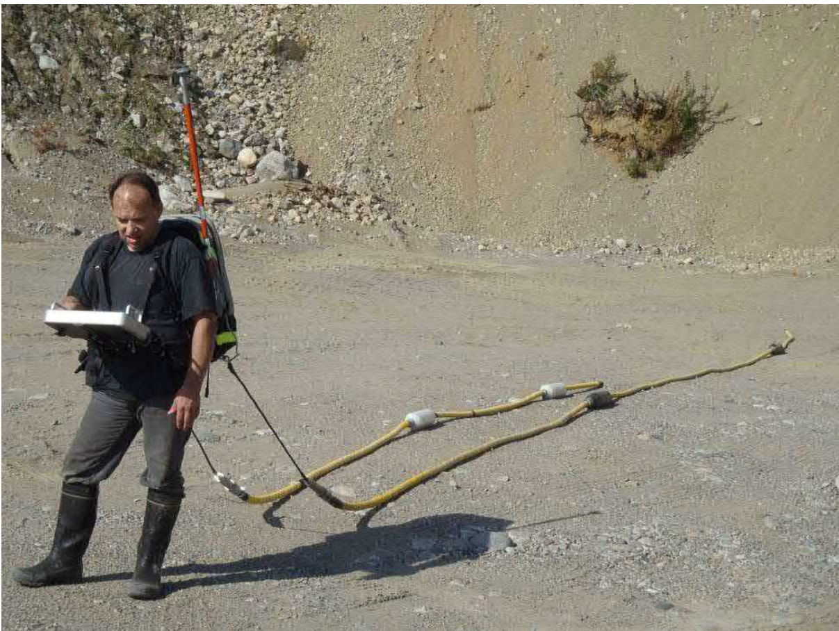
Kuva 6. Maatutkaluotausta käyttäen jalkaisin (tai autolla) vedettävää Ramac ProEx –maatutkakalustoa ja suojaamattomia Rough Terrain letkuantenneja. Repussa näkyy myös paikannukseen käytettävän tarkkuus-GPS:n antenni. Kuva A. Hyvönen, GTK.
