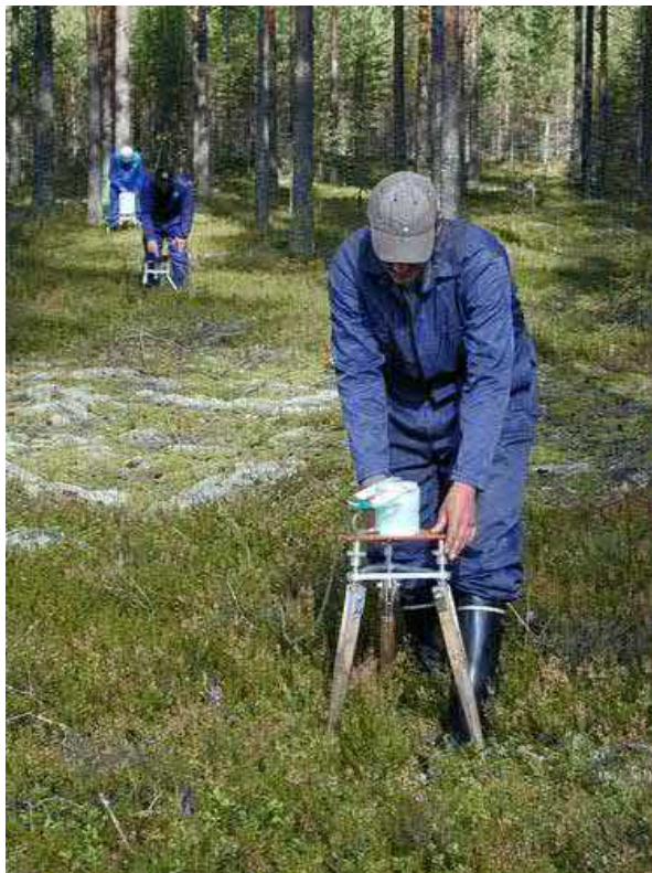
Kuva 5. Painovoimamittausta Scintrex CG5-Autograv gravimetrillä. Kuva GTK.
