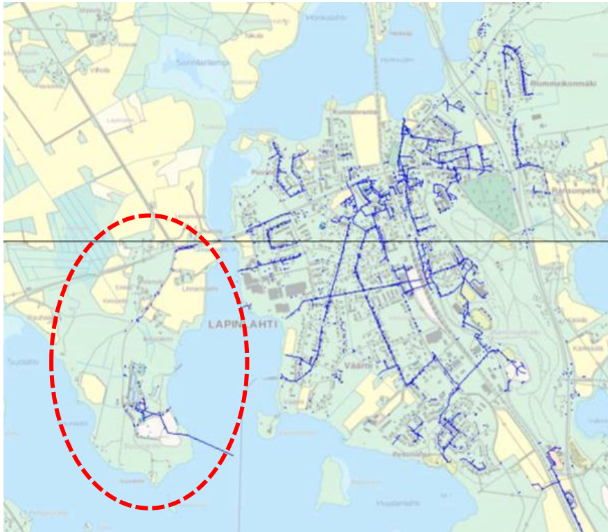
Kuva 17. Lapinlahden keskustaajaman hulevesiverkostoa. Suoniemessä on olemassa olevaa hulevesiverkostoa, kuten avo-ojia ja rumpuja. Lähde: FCG, 2016.
